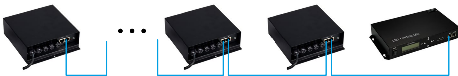
Рис 1. Все Slave-контроллеры подключаются к одному порту Master-контроллера.
