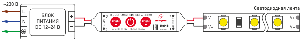
Рисунок 1. Схема подключения диммера SMART-MINI-DIM
